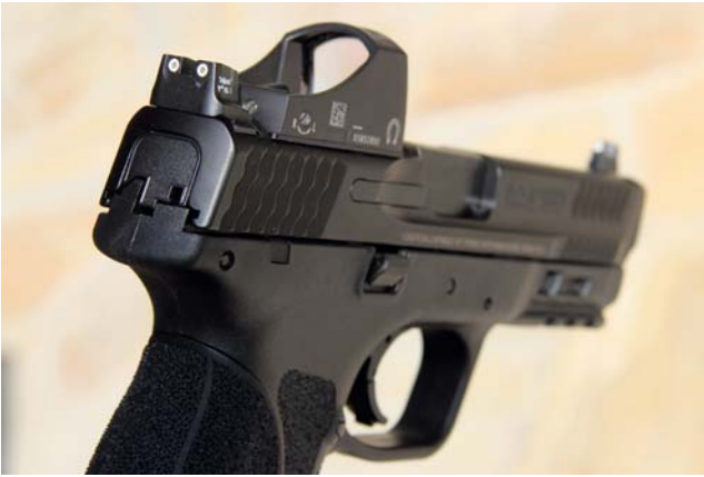
Erhöhte offene Visierung, die weiterhin in Kombination mit einem Rotpunktvisier genutzt werden kann.
